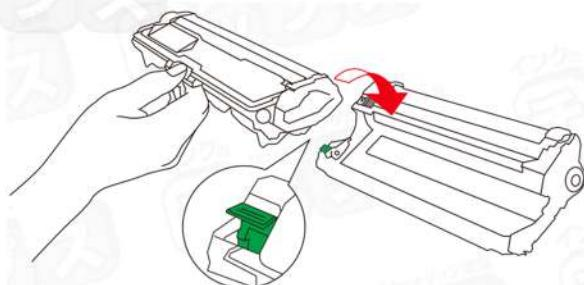
**4** ドラムユニットをプリンターの指定位置に、奥まできっちりとセットし、フロントカバーを閉じて交換完了です。
