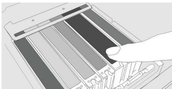
インクカートリッジをセットし、再度クリーニング用シートを1~2枚印刷してください。次に、ノズルチェックパターンを印刷して、色が出ていればクリーニング完了です。
