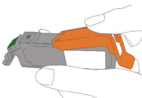
5のべた塗を1枚印刷したら、洗浄カートリッジをはずし、3の保護キャップをつけて保管してください。
