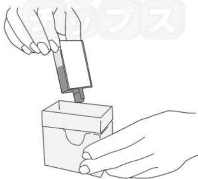
**6** 充填したインクはカートリッジ内のスポンジに吸収されるためインクは漏れません。穴をふさがらないでください。そのままプリンターにセットしてください。リセットボタンのランプが点滅した場合は10秒間ボタンを長押ししてください。
